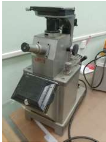
Рисунок 4.15 - Металографічний мікроскоп МІМ 7 для контролю мікроструктури
